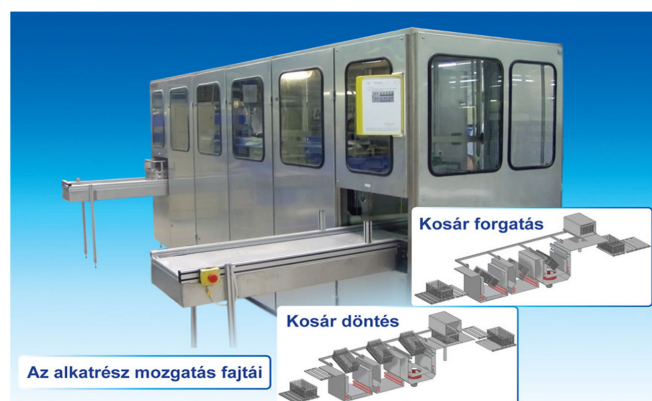
A kosármozgatási lehetőségek az ultrahangos mosóban és a hullámok hatása az alkatrészfelületen.
